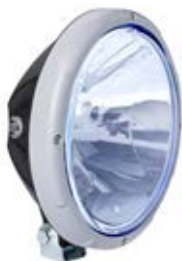
Hella Rallye 3003, Breitstrahler, blaues Leuchtglass, Ref. 37.5 Hella-Halogenstrahler, 222 mm. Schwarzes Kunststoffgehäuse mit silbernem Zierring. Echtes, transparentes Leuchtglass, Breitstrahler. H1-Leuchtmittel nicht enthalten. Empfohlene Ersatzglühlampe H1 HD Premium: Scania-Teilenummer 1905134. Artikelnr. 1906615
