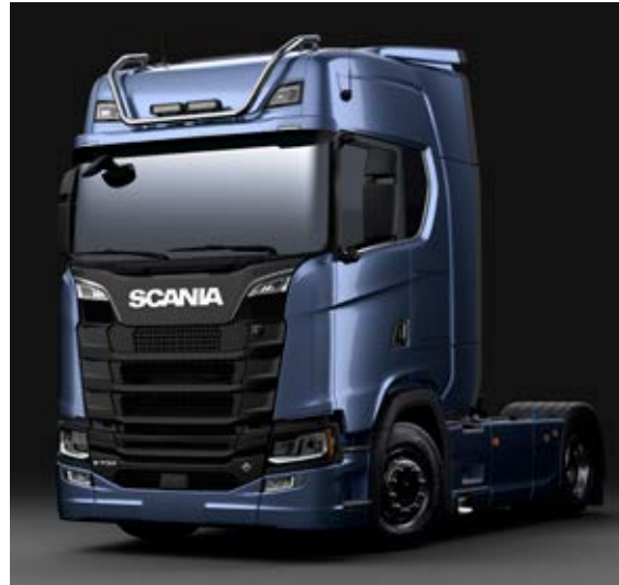
Scania Dach-Scheinwerferbügel für hohes Dach, kurze Ausführung ohne LED Scheinwerferbügel aus poliertem Edelstahl, 60 mm. Kurze Ausführung für hohes Fahrerhaus, ohne Design-LEDs. Vorverkabelt und feste Halter für 4 Zusatzleuchten (Leuchten nicht enthalten). Artikelnr. 2433091
