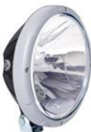
Hella Rallye 3003, Breitstrahler, transparentes Leuchtglass, Ref. 37.5 Hella-Halogenstrahler, 222 mm. Schwarzes Kunststoffgehäuse mit silbernem Zierring. Echtes, transparentes Leuchtglass, Breitstrahler. H1-Leuchtmittel nicht enthalten. Empfohlene Ersatzglühlampe H1 HD Premium: Scania-Teilenummer 1905134. Artikelnr. 1906614
