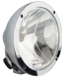
Hella Luminator Chromium Clear Compact, Breitstrahler, klares Leuchtenglas, Ref. 37.5 Hella-Halogenstrahler, 170 mm. Verchromtes Metallgehäuse, klares Leuchtenglas, Positionslicht, Breitstrahler. H1-Leuchtmittel, nicht enthalten. Empfohlene Ersatzglühlampe H1 HD Premium: Scania-Teilenummer 1905134. Artikelnr. 2596701
