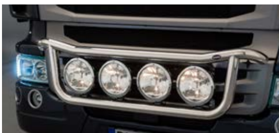
KAMA-Scheinwerferbügelsatz 2266907 + 4 x Hella 3003 (2060523) Kabel und Halter für 4 Scheinwerfer. Enthalten sind 4 Hella Rallye 3003. Ref. 50, verchromter Zierring, Teilenummer 2060523. Artikelnr. 2251229
