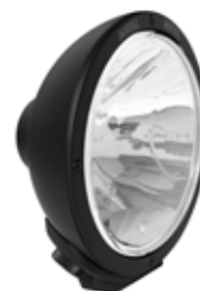
Hella Luminator Metal schwarz, Breitstrahler, klare Streuscheibe, Ref. 37,5 Hella-Halogenstrahler, 233 mm. Schwarzes Metallgehäuse, klare Streuscheibe, Positionslicht, Breitstrahler. H1-Leuchtmittel, nicht enthalten. Empfohlene Ersatzglühlampe H1 HD Premium: Scania-Teilenummer 1905134. Artikelnr. 1934112
