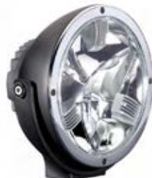
Hella Luminator LED, Nadelstrahl, klares Leuchtenglas, Ref. 50 Hella-LED-Strahler, 222 mm. Schwarzes Gussmetallgehäuse, verchromter Zierring, transparente Kunststoffscheibe, Dreifachreflektoren, austauschbarer LED-Einsatz, Nadelstrahl. Stromaufnahme 30 W, Multivolt 12–24 V. Artikelnr. 2724785
