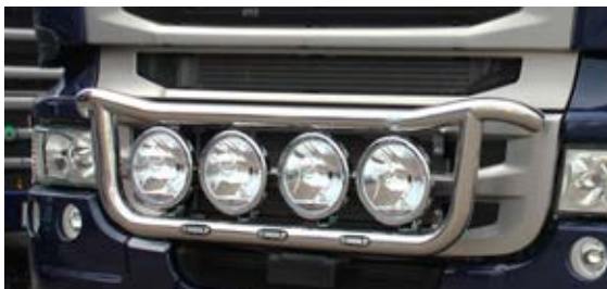
Baureihen G und R, Design wie 2266907, aber mit LED (Ohne Scheinwerfer.) Artikelnr. 2551885
