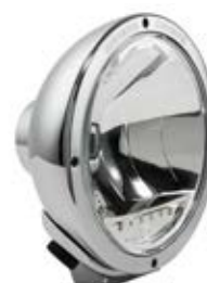
Hella Luminator Chromium Clear, Breitstrahler, klares Leuchtenglas, Ref. 37,5 Hella-Halogenstrahler, 233 mm. Verchromtes Metallgehäuse, klares Leuchtenglas, LED-Positionslicht, Breitstrahler. H1-Leuchtmittel, nicht enthalten. Empfohlene Ersatzglühlampe H1 HD Premium: Scania-Teilenummer 1905134. Artikelnr. 2254023
