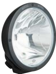
Hella Luminator Metal schwarz, Nadelstrahl, klares Leuchtenglas, Ref. 50 Hella-Halogenstrahler, 233 mm. Schwarzes Metallgehäuse, klares Leuchtenglas, Positionslicht, Breitstrahler. H1-Leuchtmittel, nicht enthalten. Empfohlene Ersatzglühlampe H1 HD Premium: Scania-Teilenummer 1905134. Artikelnr. 2254020
